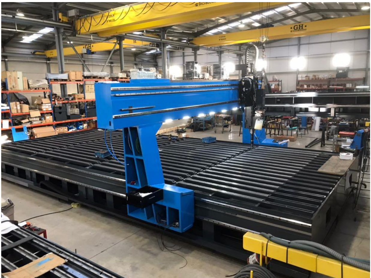
GRD 9040 (9x4 m) Abstand Spindel-Tisch 1200 mm
