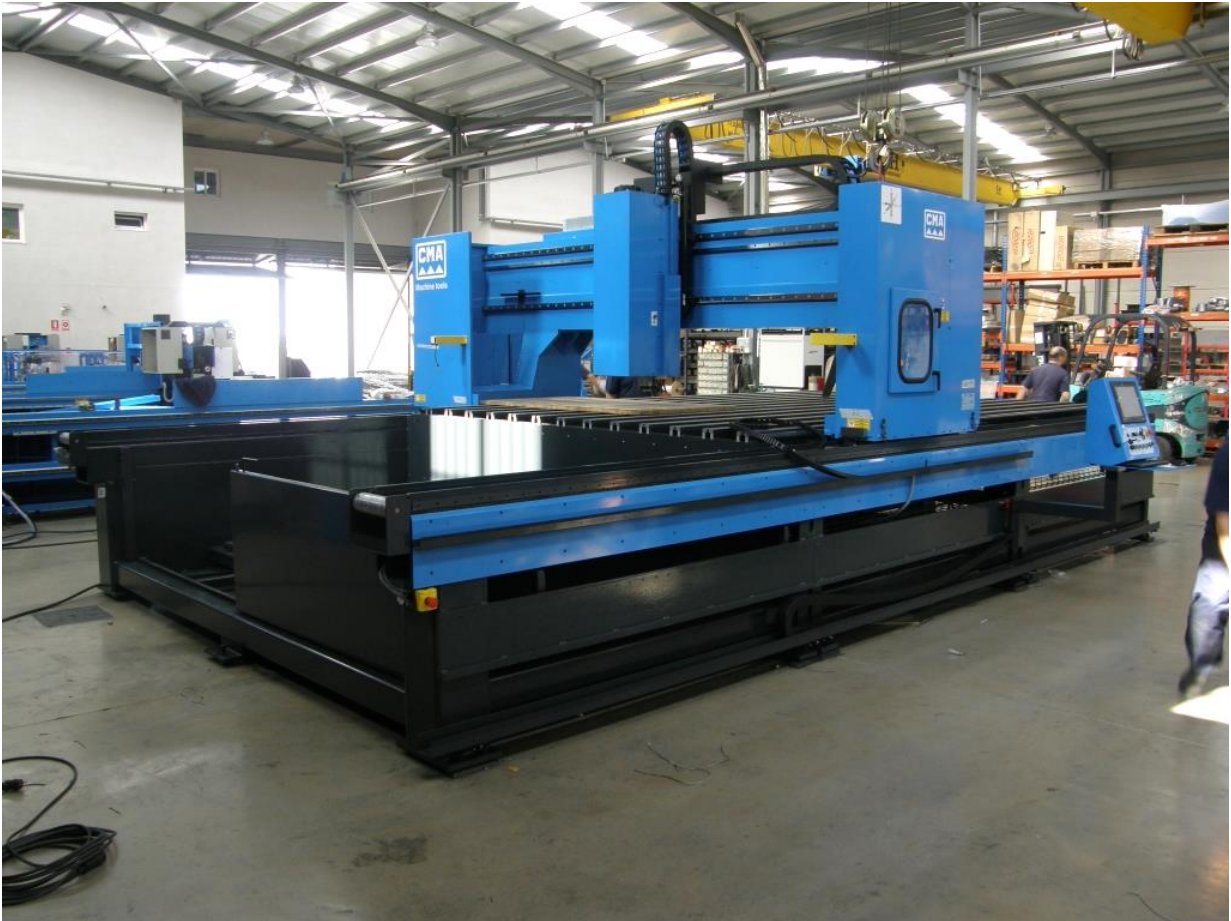
GRD 6830 (6,8x3 m) Sonderausführung mit 2 Höhen (660/1480 mm) und vertikale Aufspanntische
