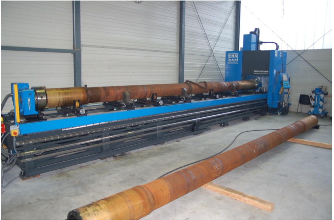
GRD 8006 (8x0,6 m) Sonderausführung für Rohre bis \varnothing 400 mm
