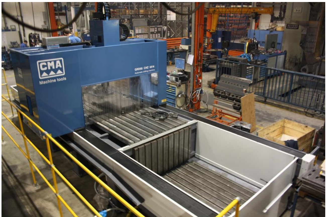
GRD 6514 (6,5x1,4 m) Sonderausführung mit 2 Höhen (660/1480 mm) und vertikale Aufspanntische
