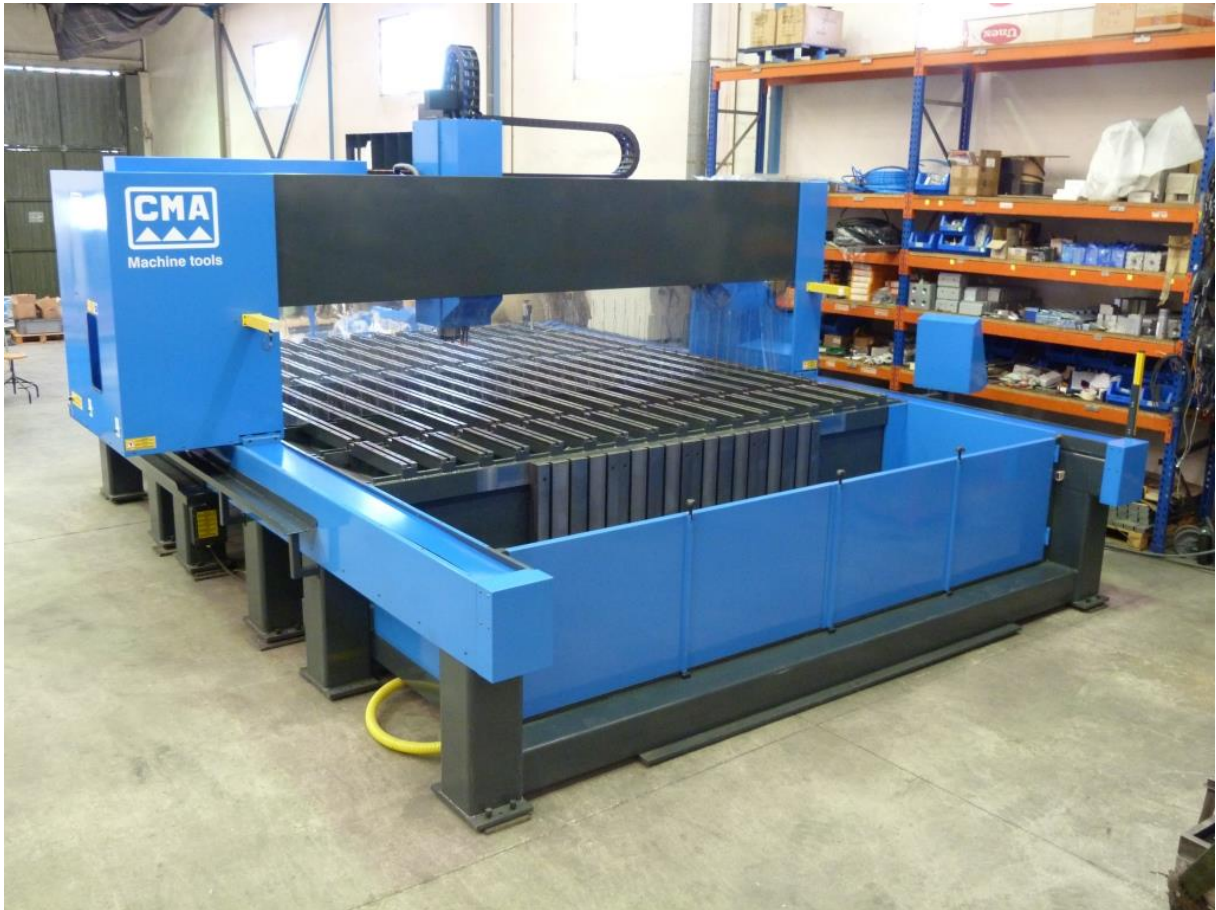
GRD 4535 (4,5x3,5 m) Sonderausführung mit 2 Höhen (660/1480 mm) und vertikale Aufspanntische
