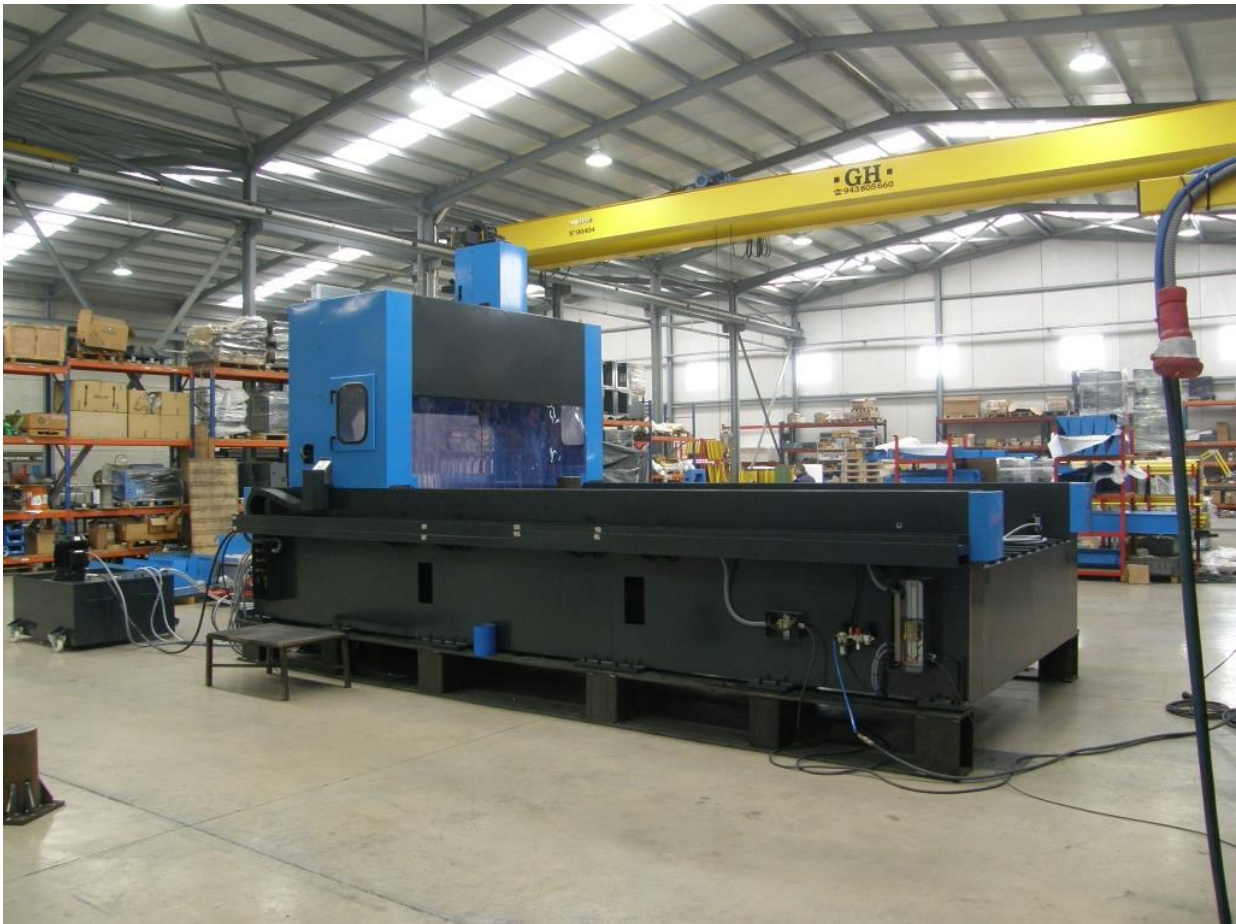
GRD 4020 (4x2 m) Sonderausführung für 400 mm Bohrtiefe \varnothing 60 und \varnothing 18 mm
