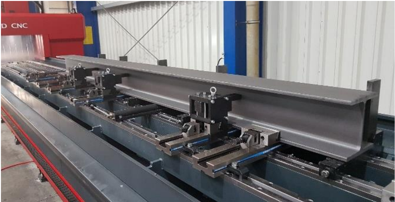
Träger bis 300 oder 400mm hoch / Bohren, Fräsen, Senken usw.
