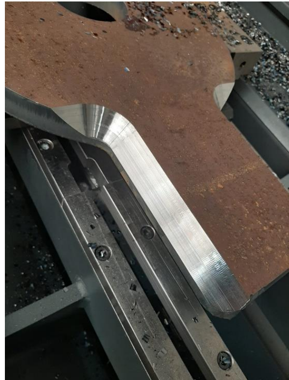
Fasenfräsen 30 hoch in mehreren Durchgängen, Vorschub 2500mm/min
