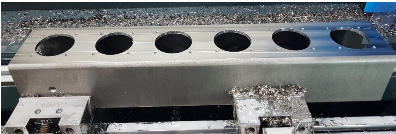
Rohr planfräsen, Löcher Ø90, Gewinde M8
